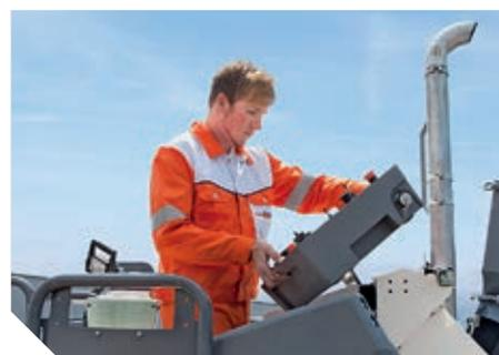
Pupitre de commande pouvant être placé à droite ou à gauche pour une visibilité optimale ▲
