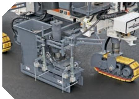
Le coffrage glissant peut être télescopé vers l'extérieur par commande hydraulique jusqu'à 700 mm ▲
