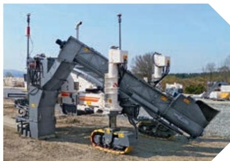
▲ Le coffrage glissant peut être monté soit à droite, soit à gauche – la transformation s'effectue en un rien de temps
