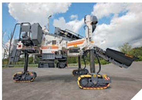
◀ Réglage hydraulique de la course allant jusqu'à 1 000 mm (réglage mécanique supplémentaire : 280 mm)
